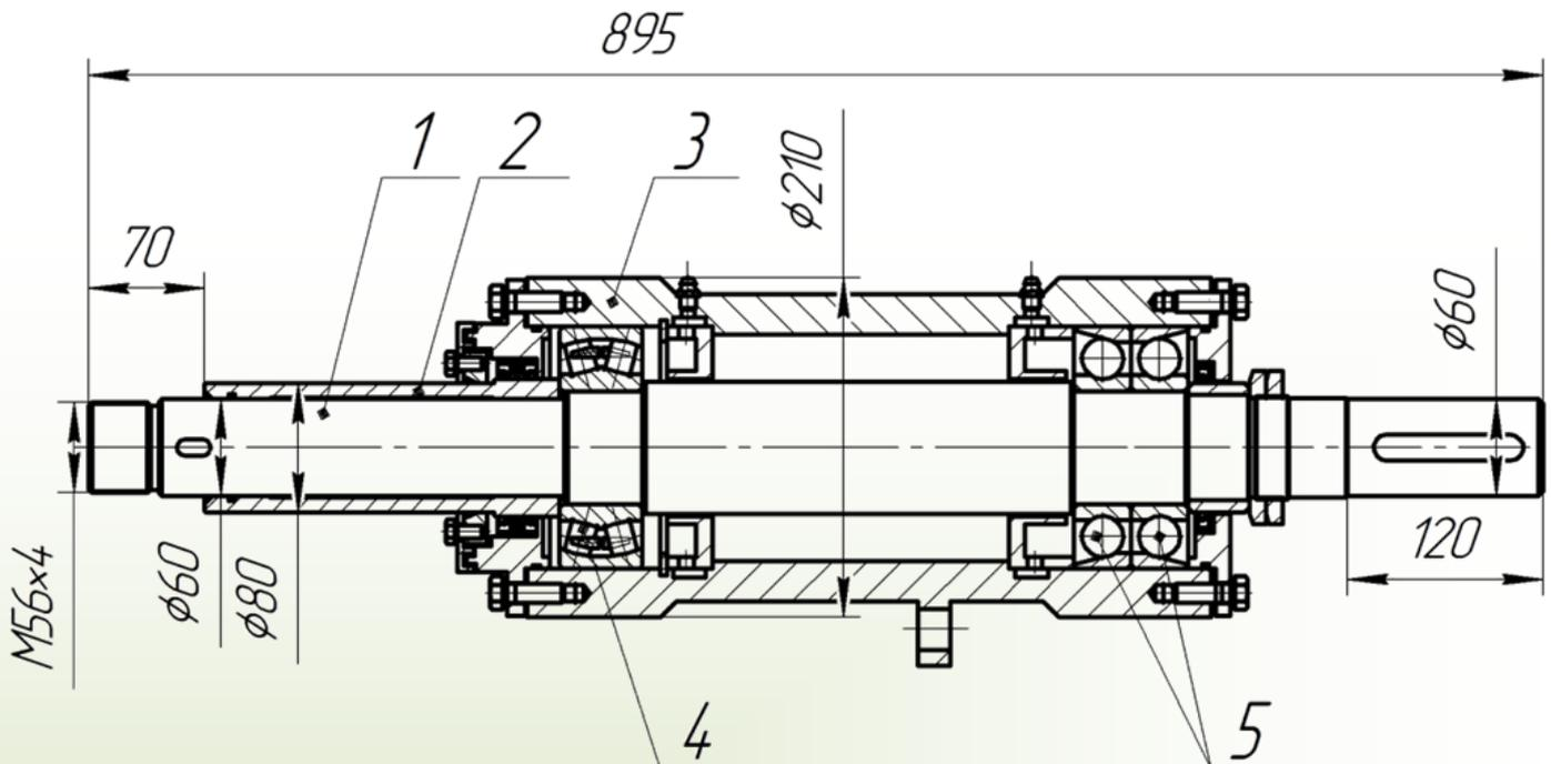
1- вал, 2- рубашка вала, 3- корпус подшипников, 4- подшипник 3614 ГОСТ 5721-75, 5- Подшипник 66314 ГОСТ 831-75.
