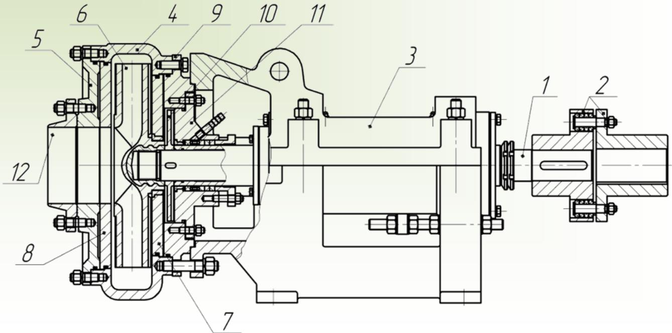
1- вал, 2- муфта, 3- станина, 4- корпус спиральный, 5- крышка, 6- колесо рабочее, 7,8- бронедиск, 9- фланец, 10- импеллер, 11- корпус сальника, 12- фланец всасывающего трубопровода.
